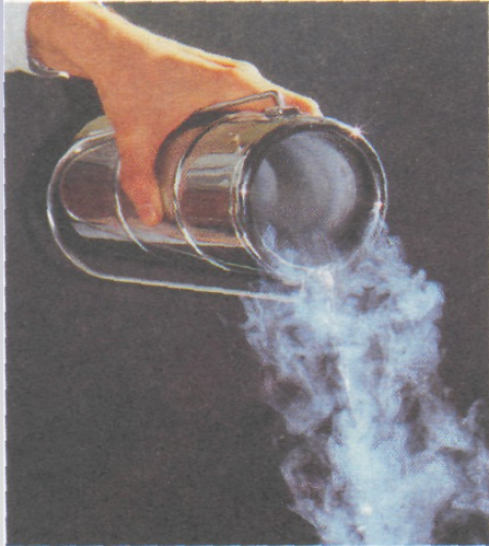
Сосуд Дьюара для хранения жидкого азота
